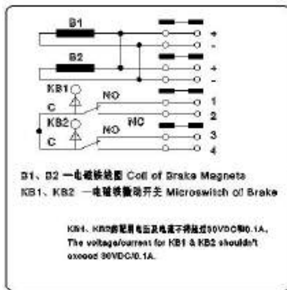
图 4-3 制动器接线盒的接线示意图 3
