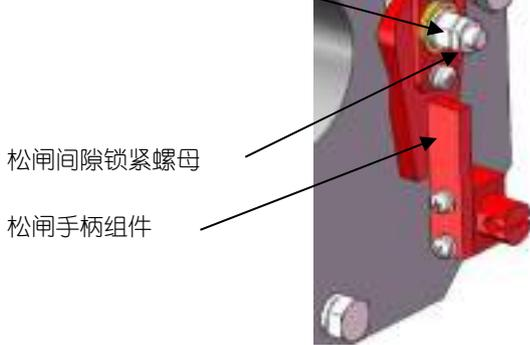
图 6 松闸手柄结构示意图
