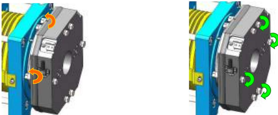
**步骤 1:** 将制动器的 6 个“螺纹导套”拧松；**步骤 2:** 完全拧紧 6 个“锁紧螺栓”，使摩擦盘的两制动面完全紧压在衔铁和曳引机后支撑上；
