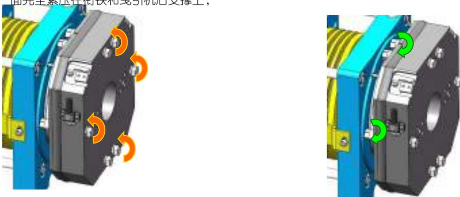
**步骤 3:** 逆时针拧松 4 个“锁紧螺栓”约 72 度，此时，**步骤 4:** 完全拧紧 6 个“螺纹导套”，制动器调整完成。摩擦盘的摩擦面与两制动面间隙大约各 0.15mm，可用塞尺测量摩擦盘的摩擦面与后支撑间隙；
