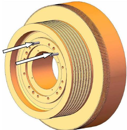
步骤 2：为保证安全，将螺径 M12 的 2 个螺钉（也可以是螺栓或螺杆，统称为安全螺钉，其最小保证长度 160）沿步骤 1 拆出的通孔拧入转子支架中，拧入深度为 20~25mm。
