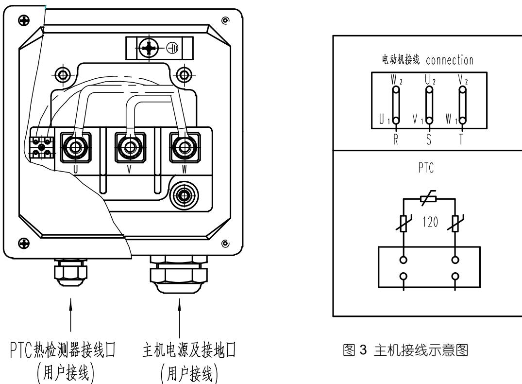
图 3 主机接线示意图
