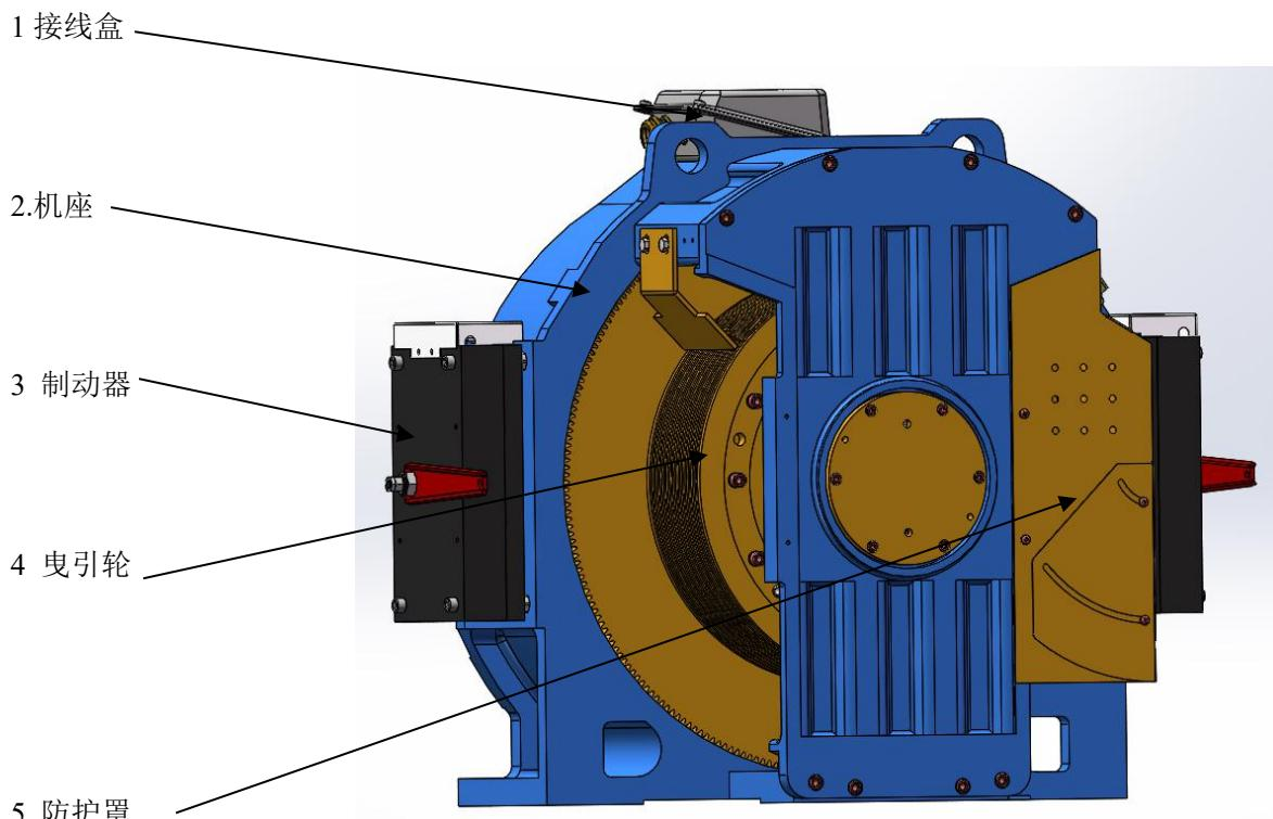
图 1 主机结构示意图
