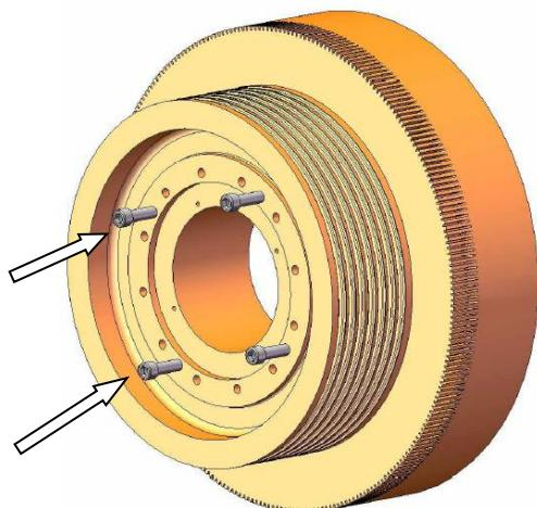
步骤 3：将螺径 M16 的 4 个螺钉（或螺栓，统称为顶出螺钉，其最小保证长度 150）拧入曳引轮预留的 4×M16 螺孔，按对角顺序交替拧入，将旧曳引轮顶出。
