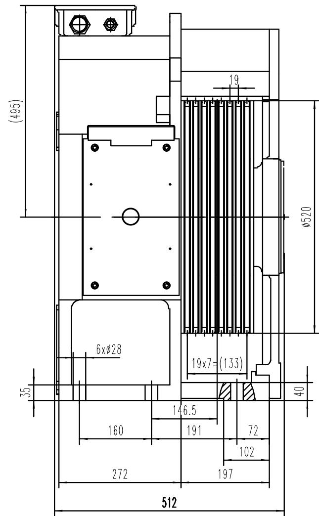
附 1 表：Mini9 曳引机的外形安装尺寸和机电参数
