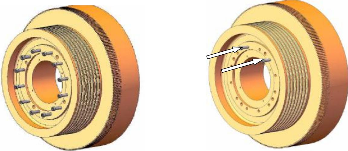
步骤 1：将固定曳引轮的 12 个 M 12 螺钉拆除。 步骤 2：为保证安全，将螺径 M12 的 2 个螺钉（也可以是螺栓或螺杆，统称为安全螺钉，其最小保证长度 160）沿步骤 1 拆出的通孔拧入转子支架中，拧入深度为 20~25mm。
