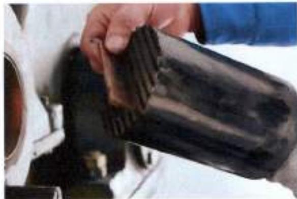
步骤 11：塞入制动器铁芯，注意记号对齐以及连接块需装到位。
