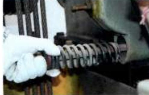
步骤 4：按图示 2 处，卡黄钳取下制动臂连接销轴挡圈，并拔出销轴，即可拆下制动臂。
