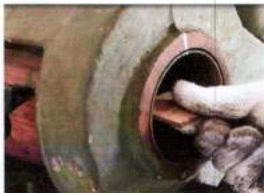
步骤 7：干净抹布，将铁芯表面擦拭干净，并检查铁芯圆周，如发现表面有台阶、不光滑需用砂纸打磨。
