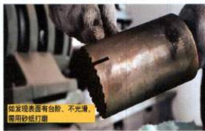
步骤 8：抹布清理擦拭制动器机座内孔和铁芯连接块。
