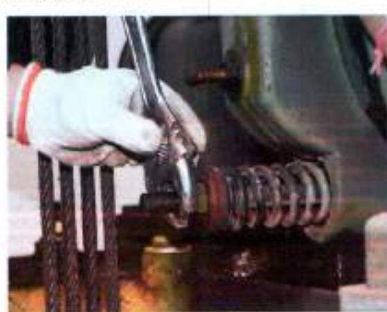
步骤 14：另外一侧套入弹簧和垫圈，并旋上 1 颗螺母。
