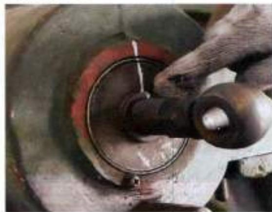
步骤 12：装回制动臂，分别塞入 2 根销轴，并用卡簧钳，装上 2 个挡圈。
